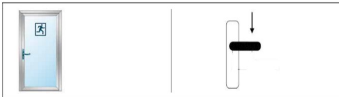
Afbeelding 32. Hoe een paniekdeur te openen met een duwbeugel volgens EN 179
