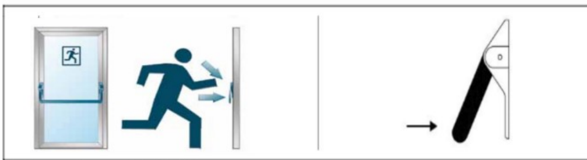
Afbeelding 33. Hoe een paniekdeur te openen met een duwbeugel volgens EN 1125
